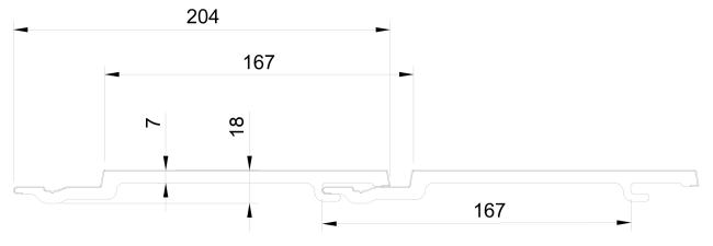
Verfügbare Längen : 5,0 m | Breite - Fassadenplatte : 204,0 mm | Breite - Fassadenplatte montiert : 167,0 mm
