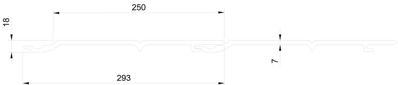
Verfügbare Längen : 5,0 m | Breite - Fassadenplatte : 293,0 mm | Breite - Fassadenplatte montiert : 250,0 mm
